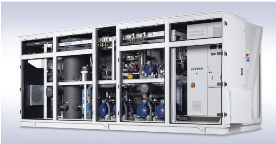
Bild 5 CO2-Booster-Kompaktsystem, mit halbhermetischem Kolbenkompressor, Ölabscheider, Schaltschrank etc. für Supermarktkühlung
