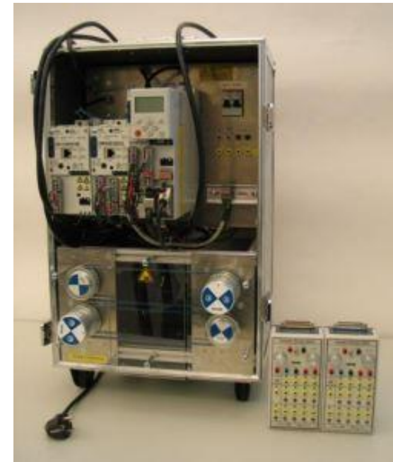
La valise 8400 contient 3 variateurs 8400 StateLine, HighLine et TopLine pour répondre au mieux au matériel installé sur la machine.
